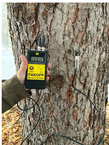
Obr. 5 Vyšetrenie kmeňa smreka ultrazvukovým prístrojom Fakopp MT.
