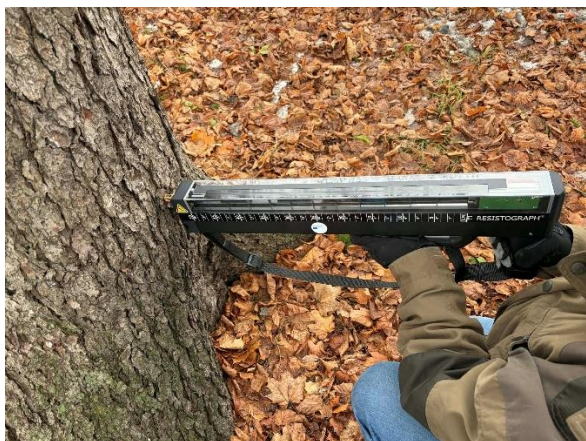
Obr. 3 Vyšetrenie kmeňa rezistografom Rinntech.
