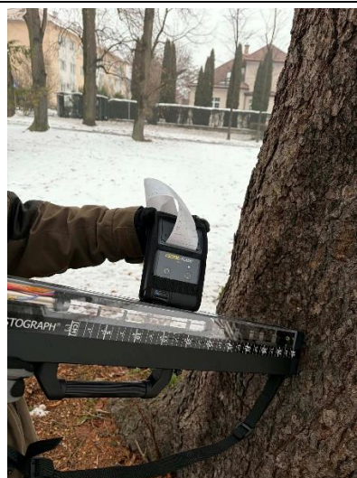
Obr. 4 Vyšetrenie kmeňa rezistografom za účelom zistenia prítomnosti hniloby.
