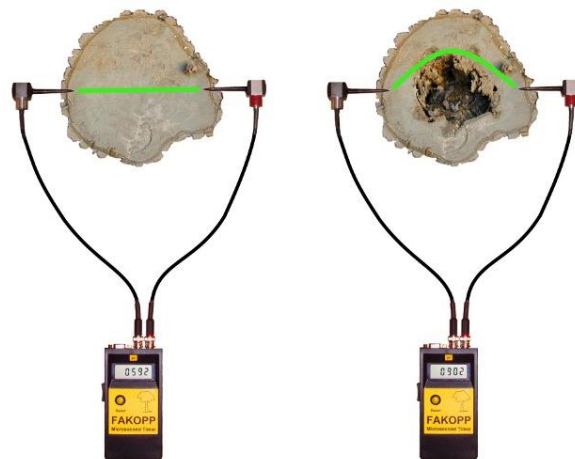
Obr. 6 Princíp detegovania hniloby (merania) ultrazvukovým prístrojom Fakopp MT.
