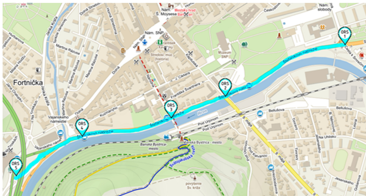
Obrázok – Navrhované prepojenie optickým káblom, situovanie skriň ORS
